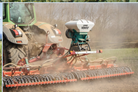
Посев промежуточных культур одновременно с рыхлением почвы культиватором
